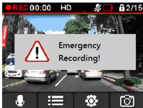
**Enregistrement d'événement par le capteur G:** Pendant un enregistrement, si le Drive Pro détecte un impact, il activera automatiquement le mode d'enregistrement d'urgence.
